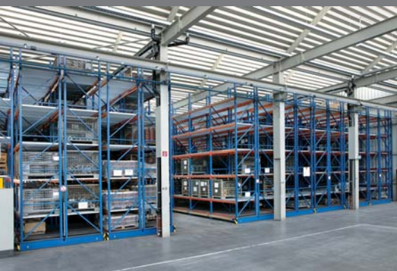
Im Werk an den Kocherwiesen ist die 2-Platzlagerung mit Längseinlagerung in Gitterboxen charakteristisch
